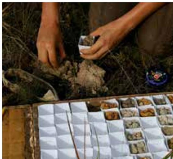
Prélèvement et stockage d'un échantillon de sol
